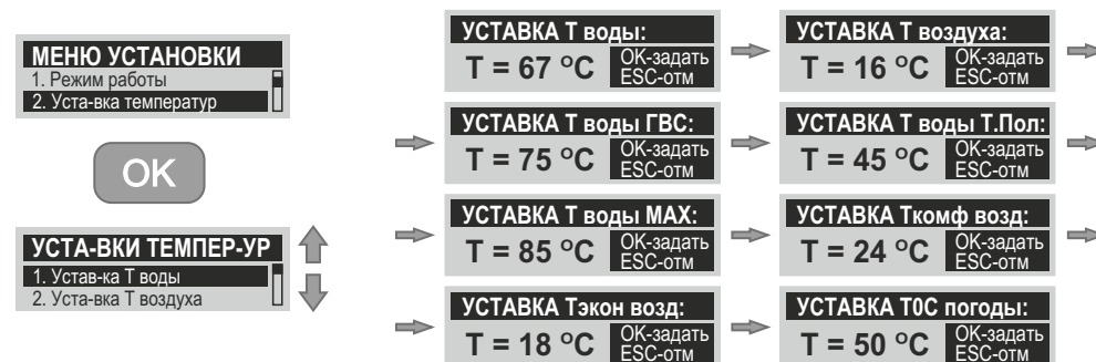
Рисунок 22. Установка температурных параметров
