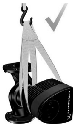
Рис. 7 Правильный способ строповки насоса
