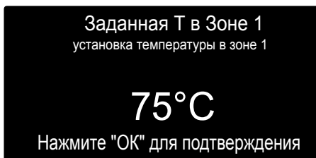
Изменение температуры горячей воды отопления
