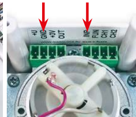
Фото 9. Клеммы подключения проводных датчиков — INP, GND
