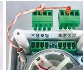
Фото 18. Подключение проводного выключателя к электроприводу
