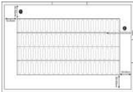
Схема укладки нагревательного мата
