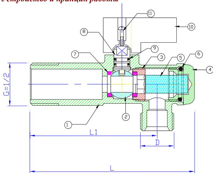
В латунном никелированном корпусе крана 1 помещается шаровой затвор 2 из хромированной латуни, уплотненный прокладками 7 из PTFE. Затвор удерживается в корпусе при помощи прижимной гайки 3, имеющей шестигранное (под ключ) проходное сечение. Затвор управляется с помощью латунного штока 8 с двумя сальниковыми кольцами 9 из EPDM. В корпус крана помещен фильтроэлемент из нержавеющей стали AISI 316. Латунная никелированная пробка фильтра 4 присоединена к корпусу через прокладку 6
