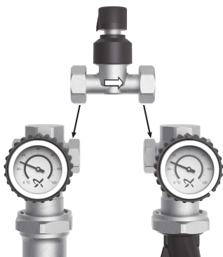
Рис. 4 Монтаж байпасного клапана
