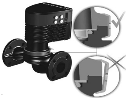
Рис. 16 Закрепление головной части насоса на корпусе насоса
