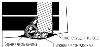
Нижняя часть зажима внутри медной токонесущей шины.
