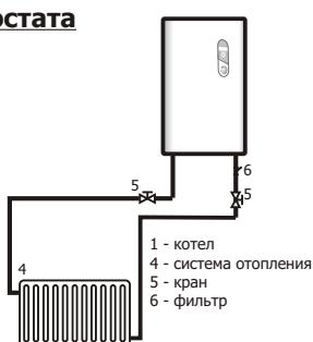
Регулирование происходит на основании установленной температуры котловой воды и гистерезиса, устанавливаемого при помощи параметра P20, диапазон 1-10 °C (этот параметр может устанавливать только сервисный техник).
