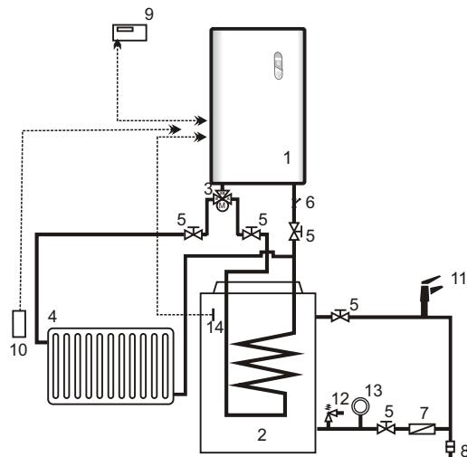
Котел будет поддерживать установленную температуру воды в бойлере с гистерезисом, устанавливаемым при помощи параметра Р21, диапазон от 1 до 10°C (этот параметр может устанавливать только сервисный техник).
