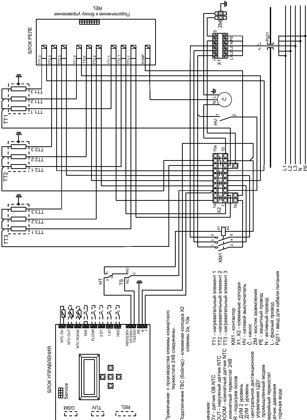
**Схема подключения котла EK18K и EK24K к трехфазной сети 3x220/380В**
