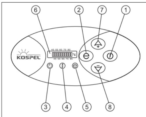
Для включения котла предназначена кнопка 1. Включение сигнализируется горящим индикатором [3]. Следует помнить, что после выключения котла циркуляционный насос работает еще около 90 секунд. Если индикатор [4] мигает, а кнопка 1 включена, значит отсутствует требуемый уровень протока теплоносителя через котел.
