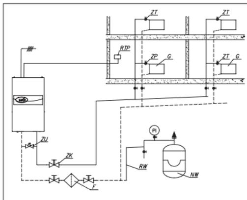
Фильтр следует установить на возврате из отопительной проводки перед входом в котел. Фильтр должен быть установлен горизонтально с обращенной вниз камерой магнитного вкладыша, направление протока должно соответствовать стрелке на корпусе фильтра.
