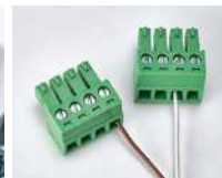
Фото 14. Подключение провода датчика к ответной части разъема
