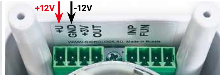
Фото 20. Клеммы разъема электропривода для подключения внешнего блока питания +12 В, проводного выключателя, объединения в систему нескольких шаровых электроприводов
