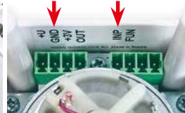
Фото 13. Клеммы подключения проводных датчиков — INP, GND
