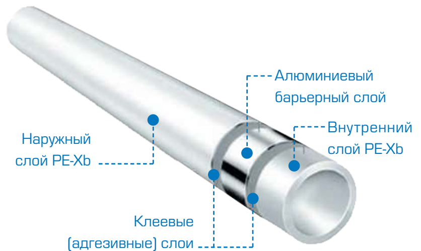
Рис. 5. Пятислойная металлополимерная труба PE-Xb/Al/PE-Xb
