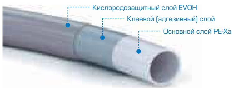
Рис. 1. Трехслойная труба РЕ-Ха/EVOH
