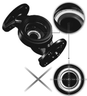
Рис. 15 Неправильно выровненная система уплотнений
