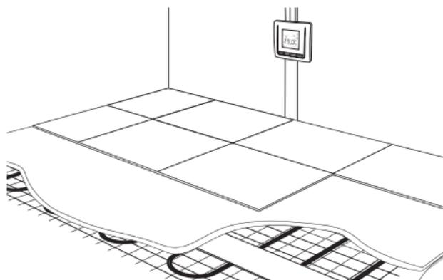
4.10. В случае использования в качестве декоративного напольного покрытия ламината, линолеума или ковролина схема укладки нагревательного мата будет следующей:
