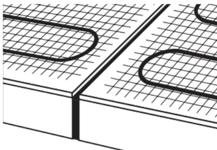
В случае, если здание имеет термокомпенсационные швы, нагревательные маты теплого пола должны быть расположены так, чтобы исключалась всякая возможность прохождения кабеля нагревательного мата через шов.
