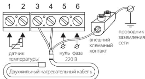
*Схема подключения к 3-х проводной электрической сети*
