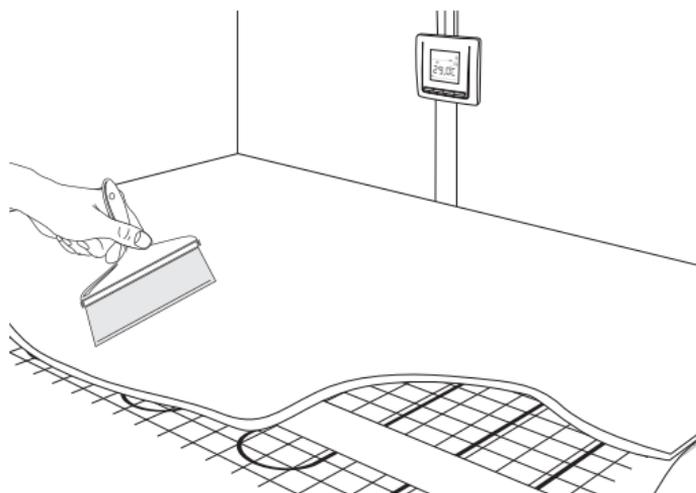
камень и т. д.) залейте нагревательный мат слоем плиточного клея толщиной 5–8 мм, не допуская образование пузырей, поднятия нагревательного мата.
