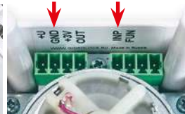
Фото 13. Клеммы подключения проводных датчиков — INP, GND
