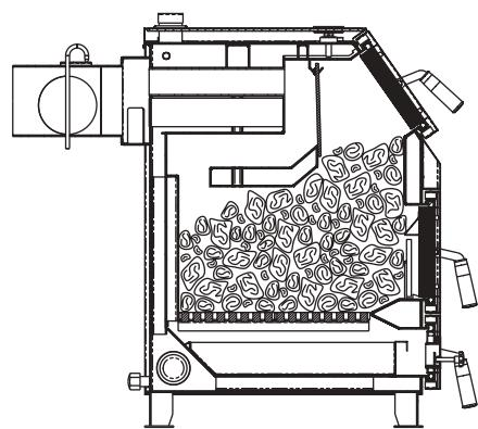
**Рис.4 Заполнение котла топливом для режима длительного горения**
