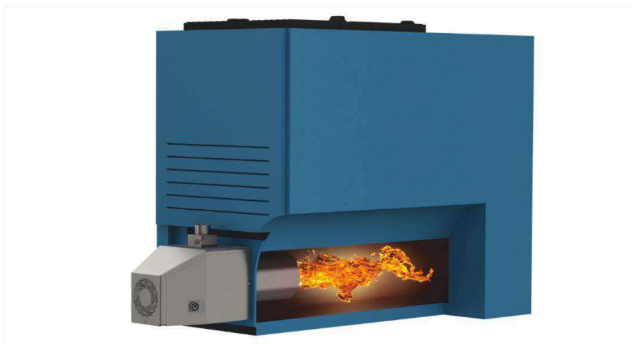
Рис. 3. Размещение горелки с учётом направления пламени.
