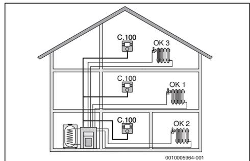
Рис. 3 Пример отопительной системы с тремя отопительными контурами с пультом C 100 как регулятор на каждом (многоквартирный дом)
