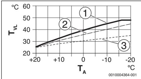
Рис. 11 Настройка отопительной кривой для обогрева пола
