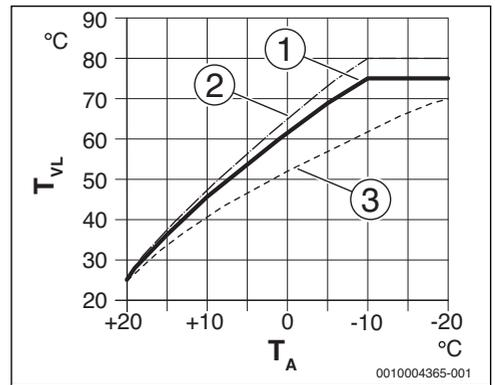
Рис. 13 Настройка отопительной кривой для радиаторов
