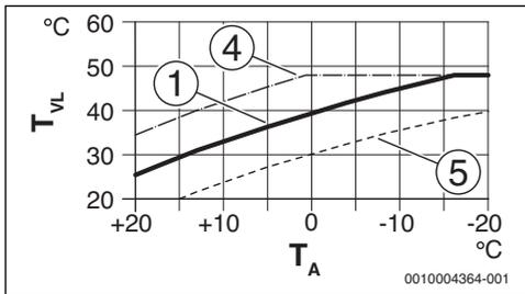
Рис. 12 Настройка отопительной кривой для обогрева полов
