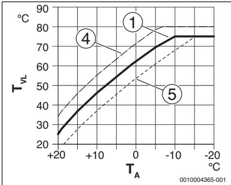
Рис. 14 Настройка отопительной кривой для радиаторов
