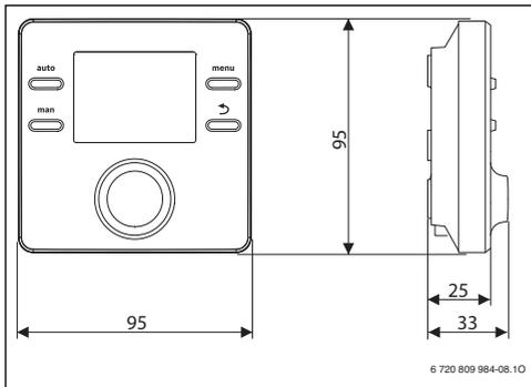
Рис. 5 Размеры, мм
