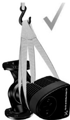
Рис. 7 Правильный способ строповки насоса
