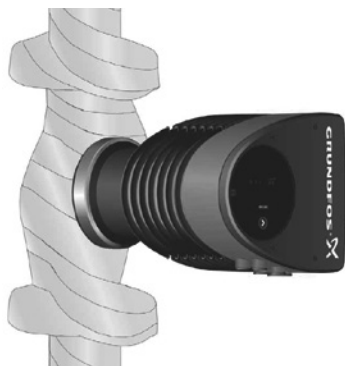
Рис. 17 Изоляция корпуса насоса и трубопровода
