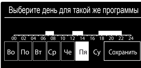
Выбор дней почасовое программирование отопления
