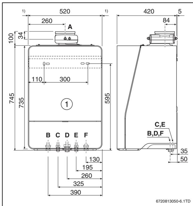
Рис. 4 Тип E - размеры и подключения [мм]
