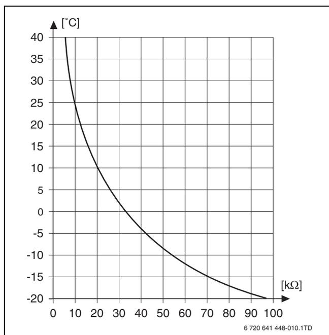
Рис. 11 Характеристика сопротивления датчика наружной температуры
