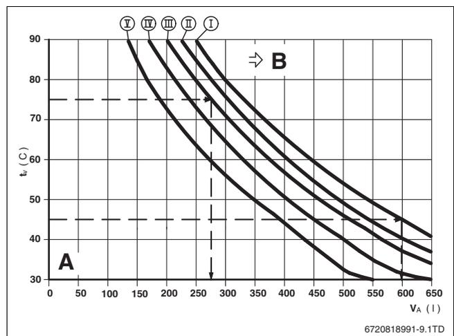
Рис. 18 Характеристики расширительного бака отопления 15 л
