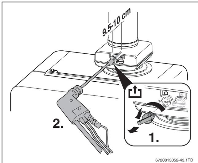
Рис. 29 Измерение содержания CO/CO<sub>2</sub>
