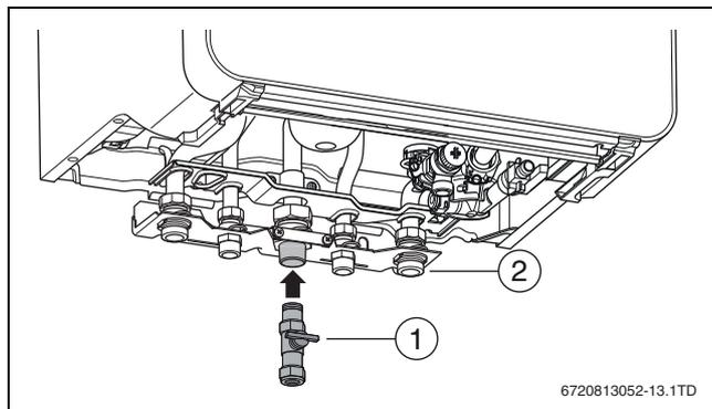
Рис. 15 Подключение газа
