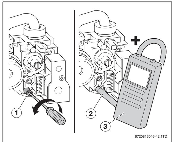
Рис. 27 Измерение подаваемого давления газа
