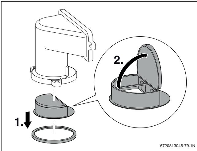
Рис. 43 Обратный клапан в смесительном устройстве
