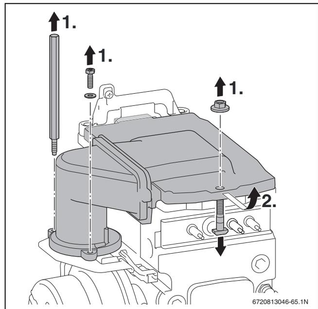
Рис. 41 Демонтаж крышки горелки
