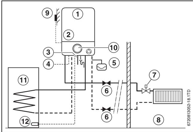
Рис. 19 Пример с регулированием по наружной температуре и с баком-водонагревателем
