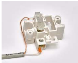
Фото 22. Подключение проводного выключателя
