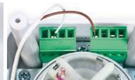
Фото 15. Подключение датчика к электроприводу
