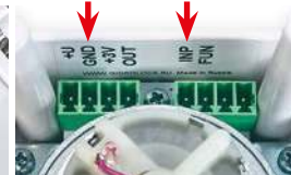
Фото 13. Клеммы подключения проводных датчиков — INP, GND
