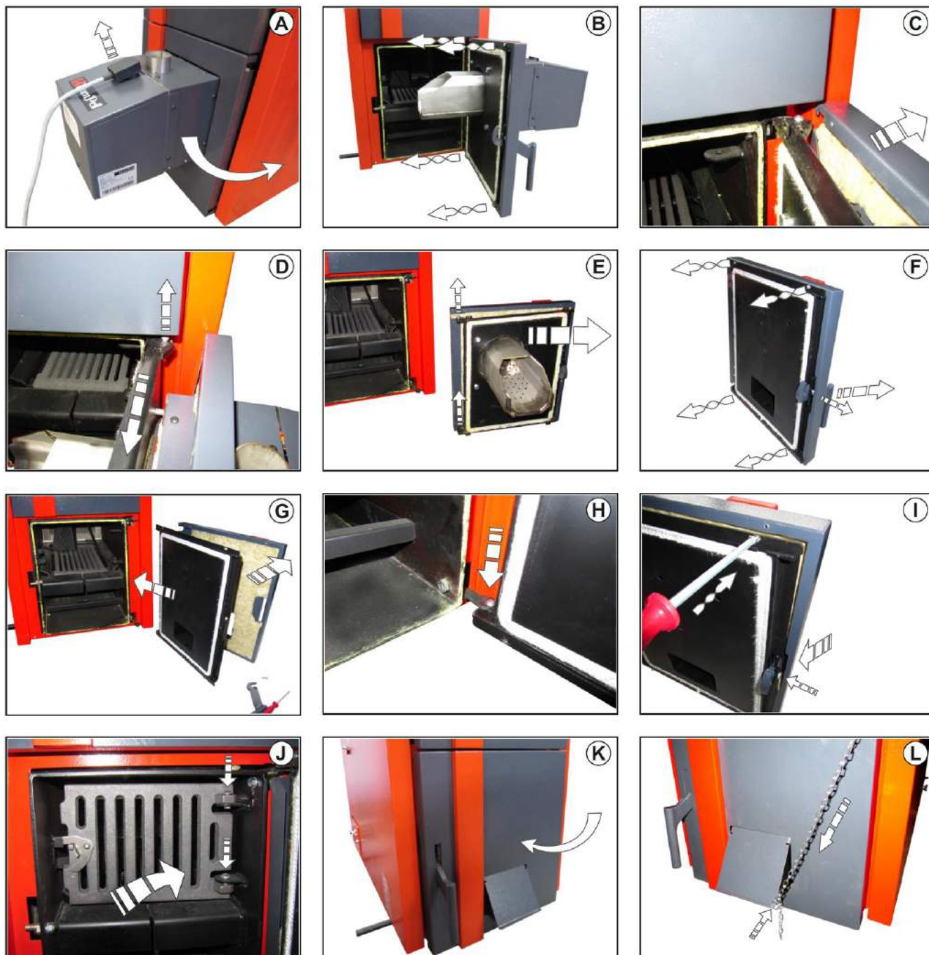
Рис.2 Замена дверец топки котла готовясь топить вручную, дровами.
