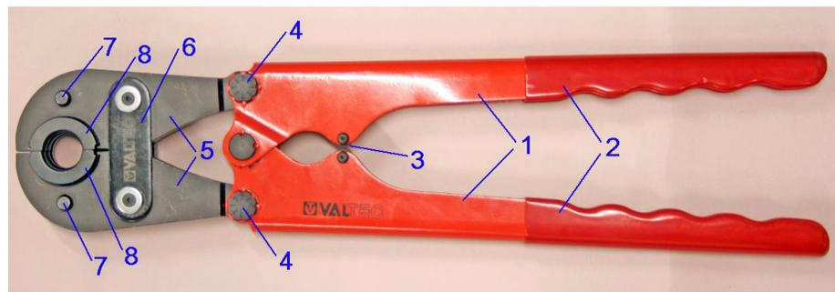
Монтажное усилие, приложенное к рукояткам (1) по принципу рычага передается на полуобоймы (5), в которых закрепляются пресс-вкладыши (8). Вкладыши фиксируются кнопочными фиксаторами (7). Планка (6) стягивает промежуточные осевые втулки. Ролики (3) предохраняют упоры рукояток от смятия. На рукоятках имеются защитное покрытие из ПВХ (2), предохраняющее руки при монтаже. Осевыми эксцентриками (4) можно корректировать настройку пресс-клещей в случае появления чрезмерных люфтов (см. раздел 4).
