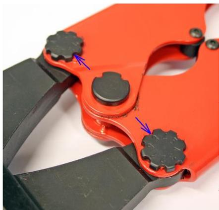
4.2. В случае, когда зазор между полуобоймами при сомкнутых рукоятках более 2мм, следует переставить эксцентрики на меньшее значение по шкале. Для этого следует развести рукоятки инструмента примерно на 30°, и открутить самоконтрящиеся гайки эксцентриков. Не рекомендуется устанавливать разные значения на эксцентриках. После установки эксцентрика в требуемое положение, гайки следует установить на место и затянуть.
