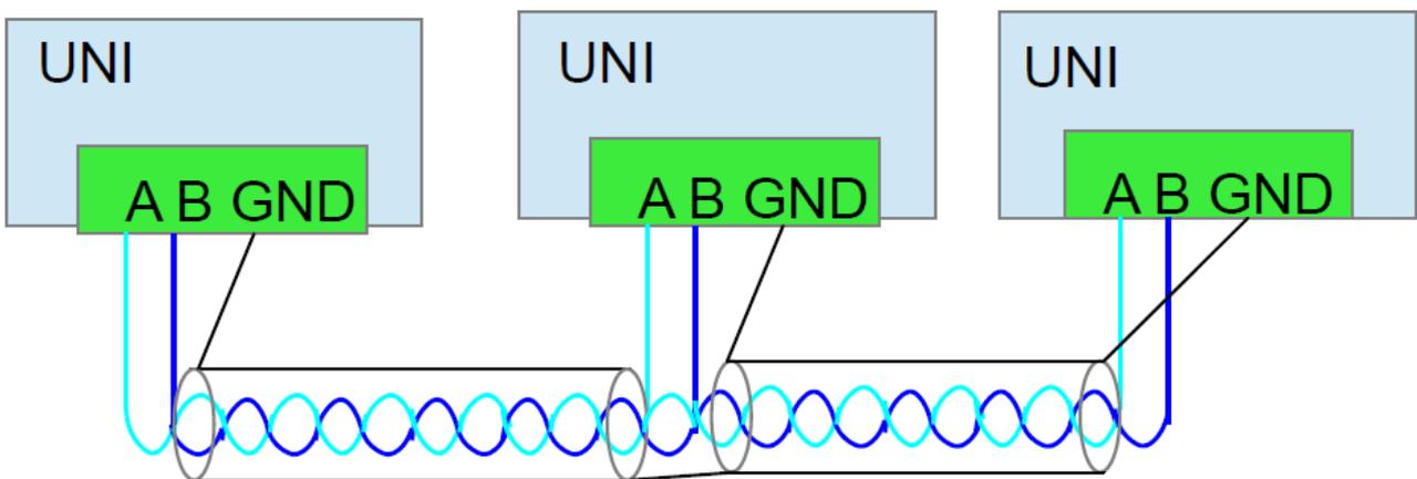
Контроллеры оснащены системой поляризации линий и устранения отражений сигнала. При коротких соединениях она окажется достаточно эффективной, но при соединениях порядка нескольких сотен метров оба конца должны быть заглушены терминальными резисторами с сопротивлением 120 Ω.
