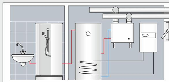
Местом подходящим для монтажа теплового насоса НРІ-4 является подсобное помещение или котельная. Тепловой насос нагревая воду, одновременно охлаждает и осушает воздух в помещениях, в которых он установлен.
