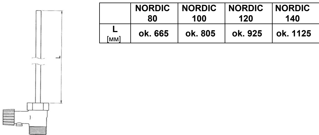
Рис. 3 Клапан с трубой развоздушивания
