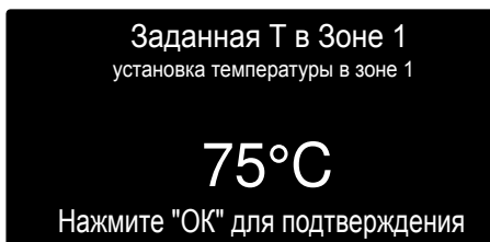
Изменение температуры горячей воды отопления
