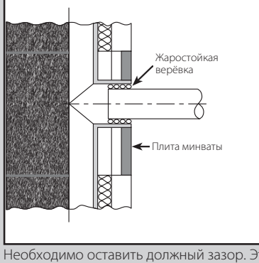
11.1 Необходимо оставить должный зазор. Этот зазор должен быть заполнен эласт. материалом (напр. жаростойкой ветовью).
