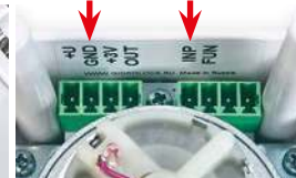
Фото 13. Клеммы подключения проводных датчиков — INP, GND
