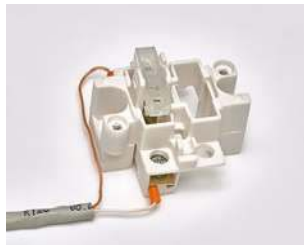
Фото 22. Подключение проводного выключателя
