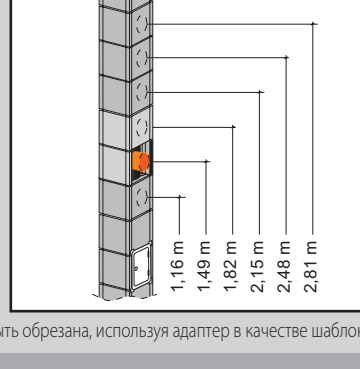
12.2 Подключение прибора на твёрдом топливе с адаптером.
