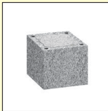
1.4 ... или каменного блока, заполненного бетоном.
