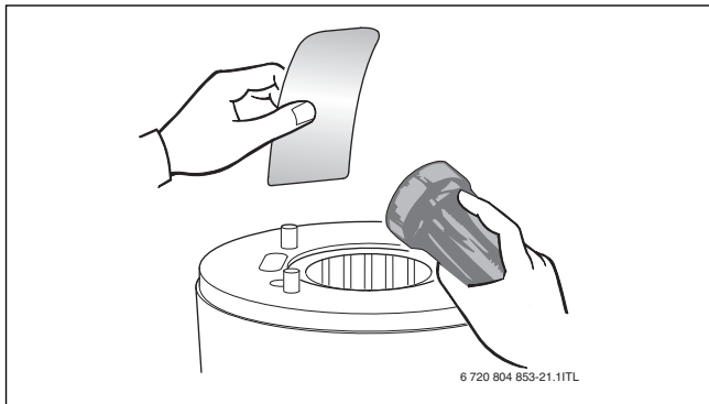
Рис. 56 Проверка наличия грязи в теплообменнике
