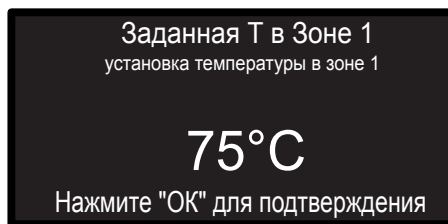
Изменение температуры горячей воды отопления
