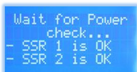
Рис. 7 – Экран проверки питания и твердотельных реле (SSR)
