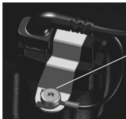
Рис. 44 Заземляющий провод датчика
