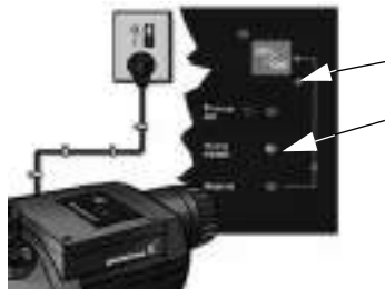
Рис. 8 Загорающиеся индикаторы при подключении сетевого кабеля
