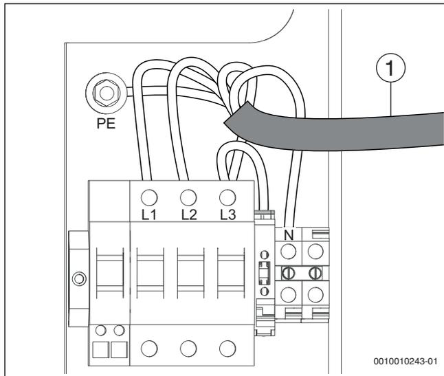
Рис. 16 Подключение к электросети 4...24 кВт, 3х 400/230 В ~
