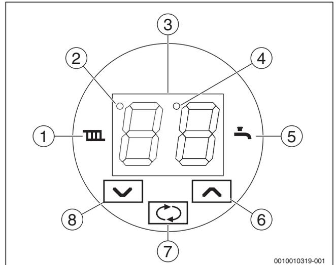
Рис. 34 Панель управления котла Tronic Heat 3000/Tronic Heat 3500
