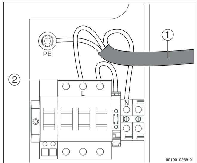
Рис. 15 Подключение к электросети 4...12 кВт, 1x 230 В ~
