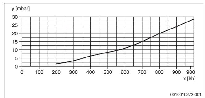
Рис. 36 Гидравлическое сопротивление Tronic Heat 3000/Tronic Heat 3500 4-12 кВт
