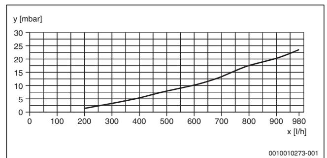
Рис. 37 Гидравлическое сопротивление Tronic Heat 3000/Tronic Heat 3500 15-24 кВт
