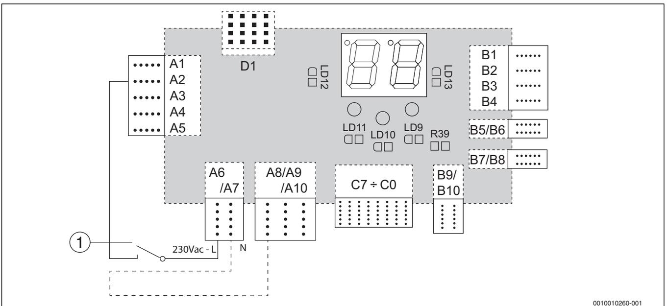
Рис. 25 Управление котлом через управление централизованным теплоснабжением (фазовый провод):
