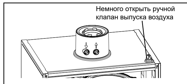
Ручной клапан выпуска воздуха
