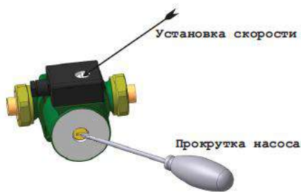
Рис. 24 Схема обслуживания насоса.
