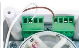
Фото 15. Подключение датчика к электроприводу
