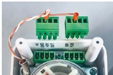
Фото 23. Подключение проводного выключателя
