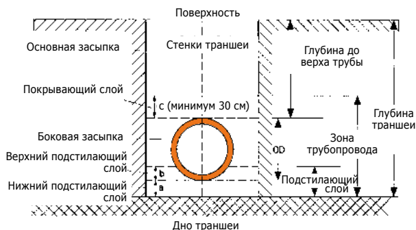
Рис. 3 Устройство траншеи
