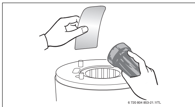
Рис. 52 Проверка наличия грязи в теплообменнике
