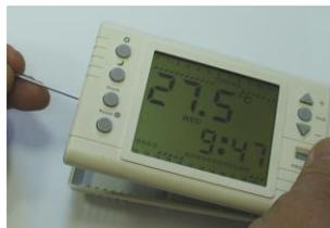
5.3. Разъедините две половины корпуса. В фасадной половине располагается батарейный отсек.
