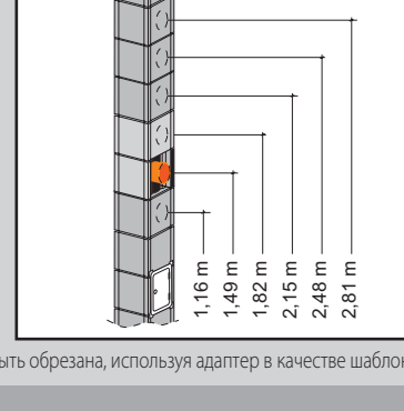
12.2 Подключение прибора на твёрдом топливе с адаптером.
