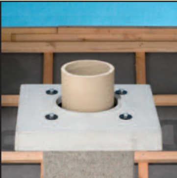
6.7 Отрежьте недостающую часть шамотной трубы и прикрепите клеем.
