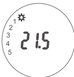
Рисунок 9. Установка температуры для периода времени
