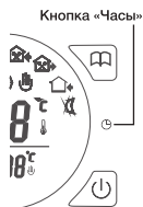
Рисунок 6. Переход в режим установки времени
