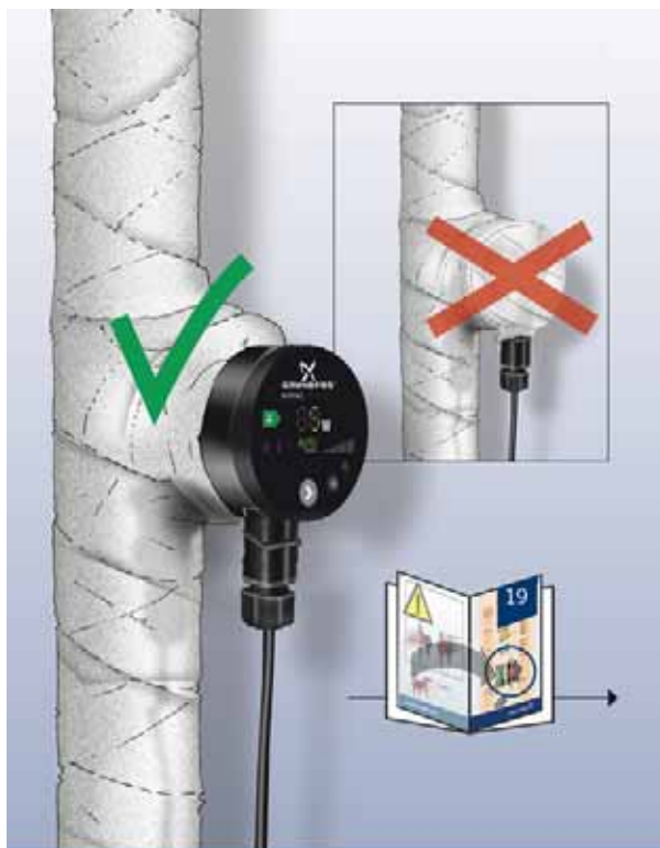
Рис. 5 Изоляция корпуса насоса
