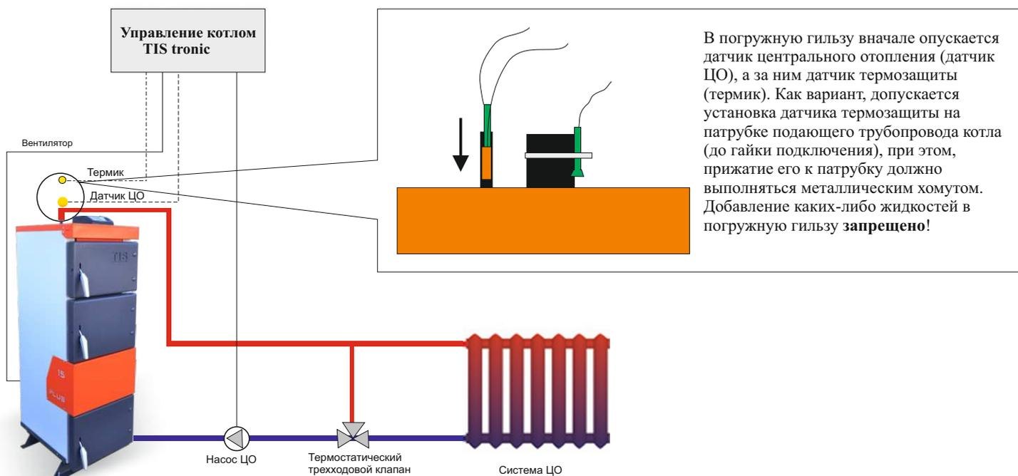
\* Схема подключения (представленная схема является примерной и упрощённой)
