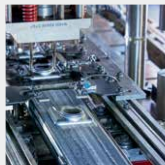
Точное изготовление половинок коллекторов
