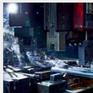
Сварка коллекторов с трубами
